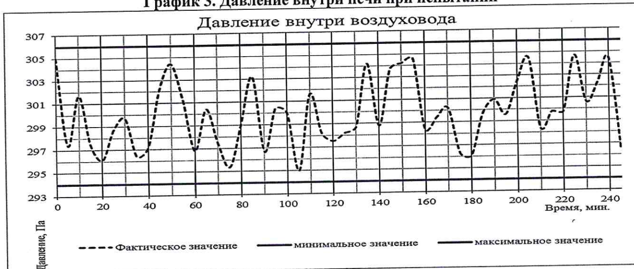
График 3. Давление внутри печи при испытании
